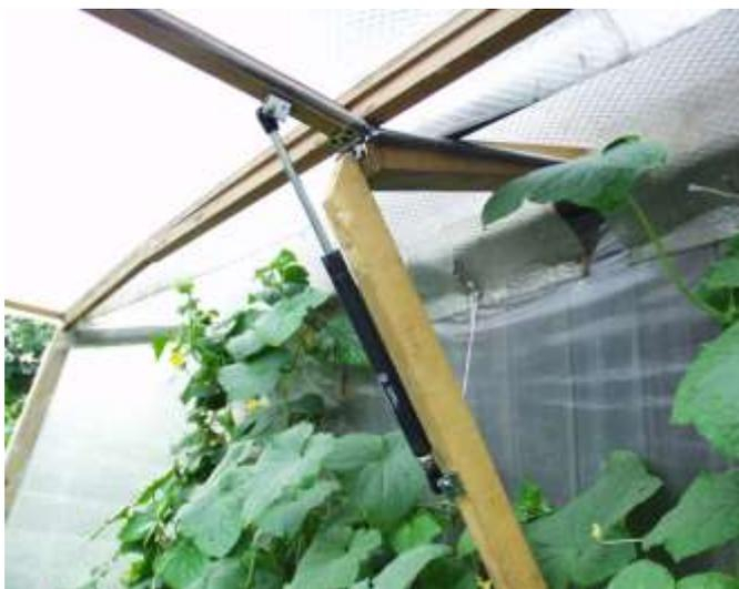
Тогда у нас ещё и в помине не было гидравлических автоматов для открывания тепличных форточек. Костя одним из первых начал делать их сам – из автомобильных масляных гидроцилиндров. Устройство очень простое. Воздух нагрелся – масло в цилиндре расширилось – шток выдвинулся и открыл форточку (фото К. Малышевского). Воздух остыл – масло сжалось и форточка закрылась. Теплица сама бережёт растения и от перегрева, и от переохлаждения. В то время это был настоящий прорыв! А сейчас у
